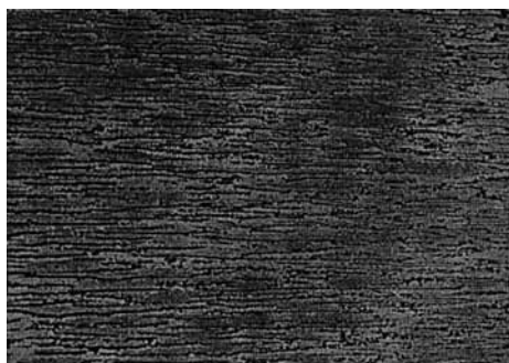
Рис. 5. Спекл-структура, полученная в свободном пространстве при освещении щелевого участка на матовом стекле при дополнительной компьютерной обработке
