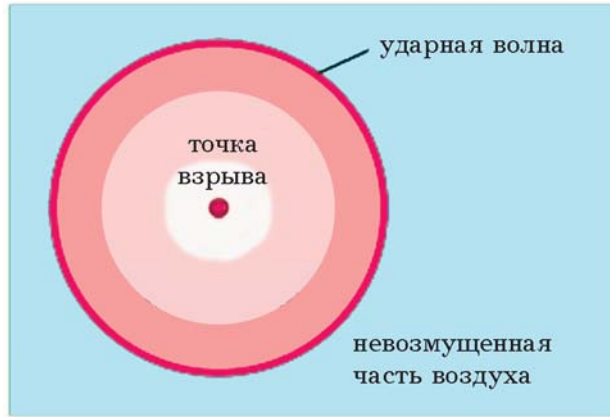
Рис. 2. Распространение сферической ударной волны от точечного взрыва
