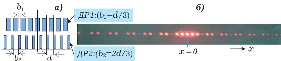
Рис. 9. (а) Дополнительные решётки, (б) дифракционная картина, полученная от решёток при нормальном падении лазерного света при отношении  $d/b = 3$
