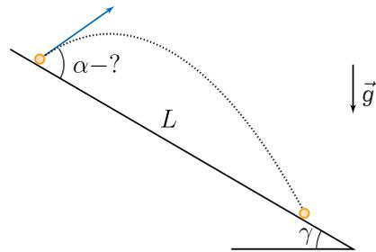
угольник перемещений – равнобедренный, следовательно, бросок необходимо совершать под углом  $\alpha = 45^\circ + \gamma/2$ .
