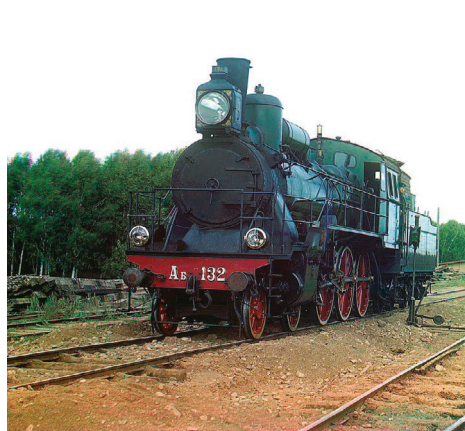
Паровоз «Компактунд» с пароперегревателем Шмидта. [1910 г.]
