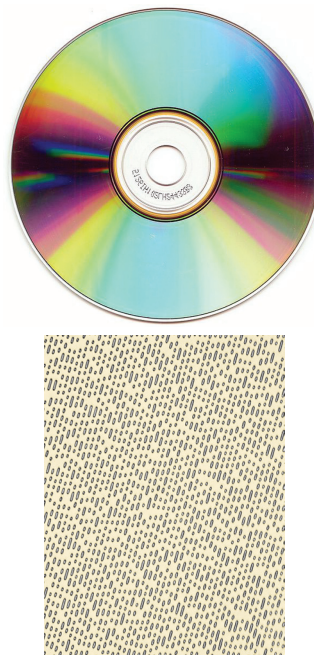
Рис. 2. Изображение компакт-диска. Полезная площадь диска составляет около 9300 кв. мм. Объём хранимой информации достигает 700 Мб. На один бит приходится 1,2 \times 1,2 кв. микрон. Снизу показана поверхность компакт-диска в 416-кратном увеличении. Способ фотографии: световой микроскоп
