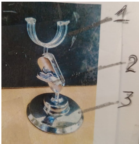
Рис. 12. Штатив крепления «USB-микроскопа»
