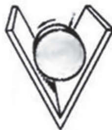
Рис. 1. Проверка ролика на «круглость».
