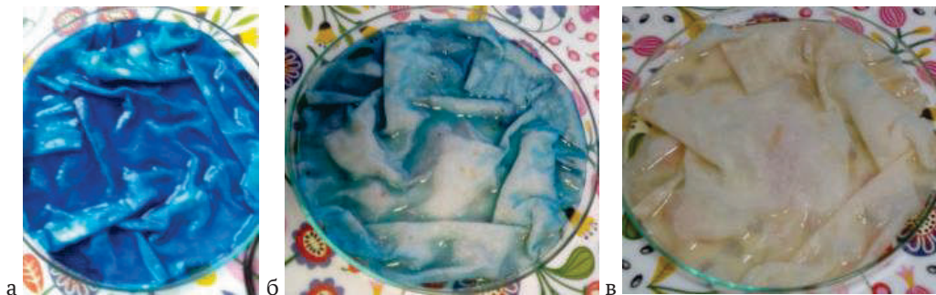
Рис. 12. Пробный процесс Фентона с участием нано-Fe 3 O 4 /HCR на салфетке: 0 мин облучения (а), 30 мин (б) и 60 мин (в)
