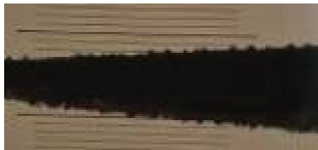
Рис. 5. Игла со сферическими образованиями после резистивного нагревания на поверхности этилового спирта, вид в оптический микроскоп
