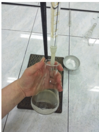
Рис. 9. Определение иода, оставшегося после реакции с сероводородом
