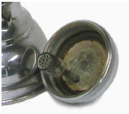
Рис. 12. Внутреннее устройство активатора воды. В решетчатую капсулу помещался кусочек руды, содержащей радий ( https://www.orau.org/ptp/collection/quackcures/quackcures.htm )
