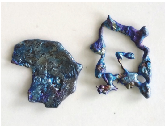
Капля застывающего свинца (слева) и кусочки затвердевшего свинца (справа)
