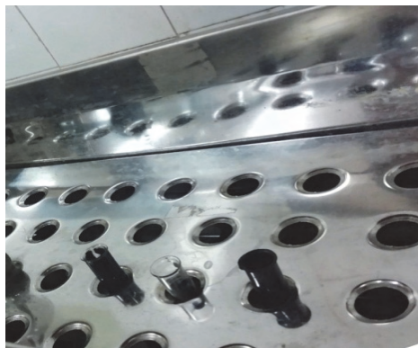
Рис 5. Термостатируемые образцы в водяной бане
