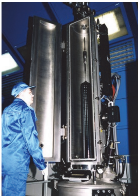
Монокристалл кремния в аппарате для выращивания ( http://www.energyland.info/img/xin/3.jpg )
