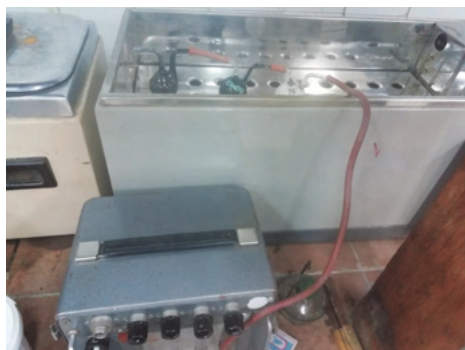
Рис. 6. Барботирование воздуха через термостатируемые образцы в водяной бане
