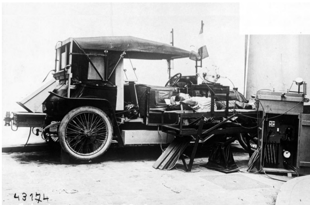
Рис. 5. Развернутая рентгеновская установка на базе машины – кюричка ( https://www.frmtr.com/tarih/6128007-daha-once-hic-gormediginiz-36-fotograf-ile-1-dunya-savasinin-teknolojisi.html )
