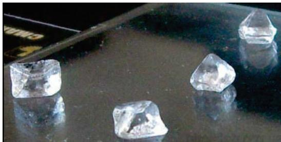
Октаэдры  $\text{NaCl}$ , выросшие в присутствии карбамида, и волокна  $\text{NaCl}$ , полученные в присутствии жёлтой кровяной соли ([http://chemistry-chemists.com/N9\\_2009/5-20.pdf](http://chemistry-chemists.com/N9_2009/5-20.pdf))
