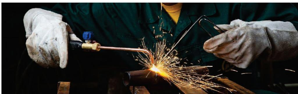
Рис. 2. Газовая сварка ([http://metal-archive.ru/uploads/posts/2017-10/1507110363\\_wumexw8m0eu4wedsfo25eoc19.jpg](http://metal-archive.ru/uploads/posts/2017-10/1507110363_wumexw8m0eu4wedsfo25eoc19.jpg))
