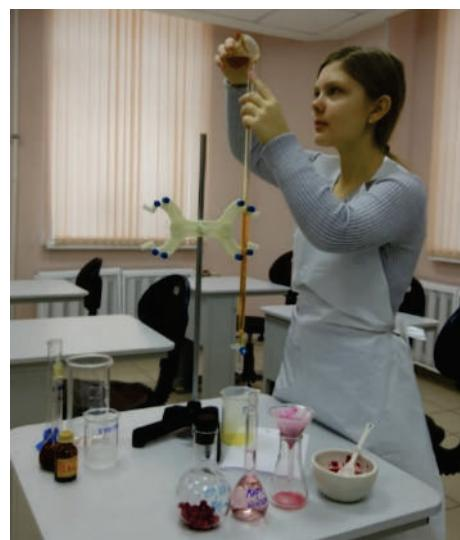
Рис. 5. Количественный анализ – титрование проб раствором иода
