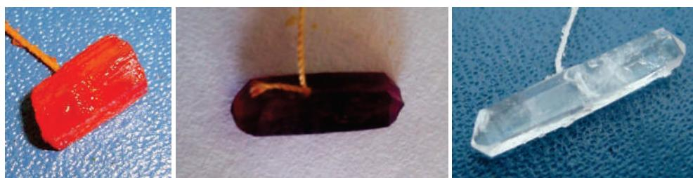
Слева направо: кристаллы  $\text{K}_2\text{Cr}_2\text{O}_7$ ,  $\text{K}_3[\text{Fe}(\text{CN})_6]$ ,  $\text{KH}_2\text{PO}_4$
