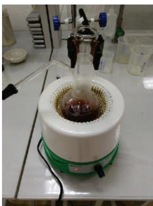
Рис. 6. Кислотный гидролиз
