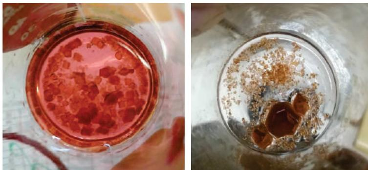
*Кристаллы кобальт-аммониевого шёнита  $(NH_4)_2Co(SO_4)_2 \cdot 6H_2O$ , полученные при 24 °C (слева) и 33 °C (справа)*
