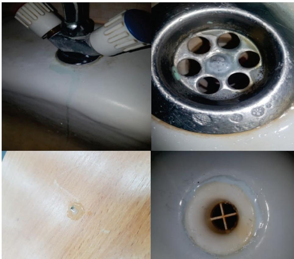
Рис. 4. Процесс барботирования при выявлении биопленок микроорганизмов при помощи индикатора BFR peroxylfilm
