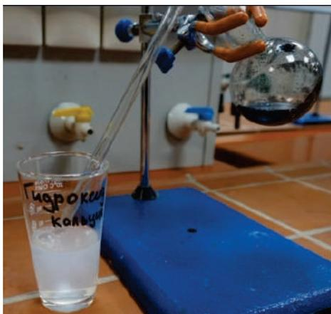
Рис. 3. Процесс образования осадка гидроксида кальция
