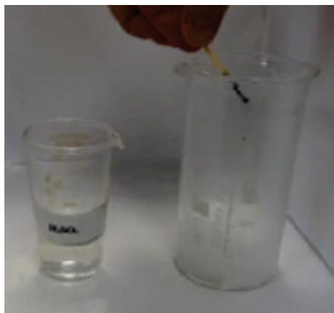
Рис. 2. Затухание подожжённой спички в стакане с выделившимся газом
