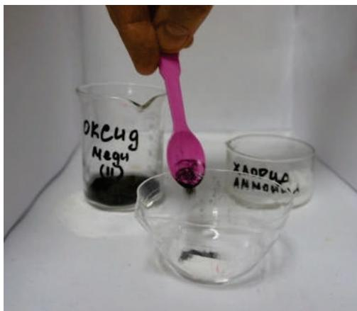
Рис. 1. Процесс получения смеси хлорида аммония и оксида меди
