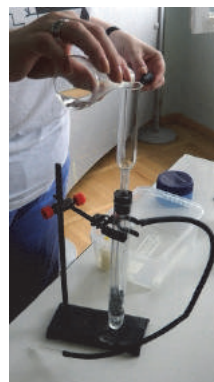
Рис. 5. Прибор для получения газов
