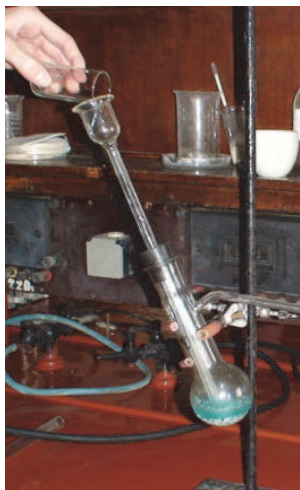
Рис. 12. Добавление раствора соли меди в колбу с цинком и кислотой
