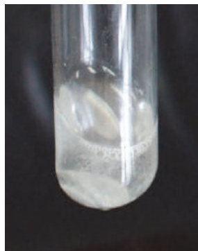
Рис. 1. Взаимодействие цинка с 20 %-ной серной кислотой
