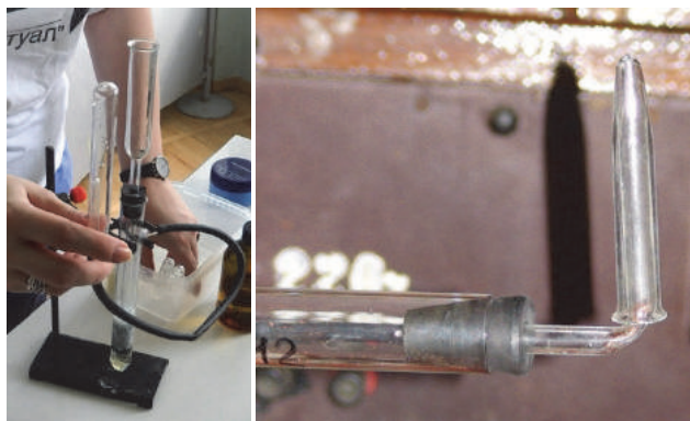
Рис. 6. Сбор водорода в пробирку из различных приборов
