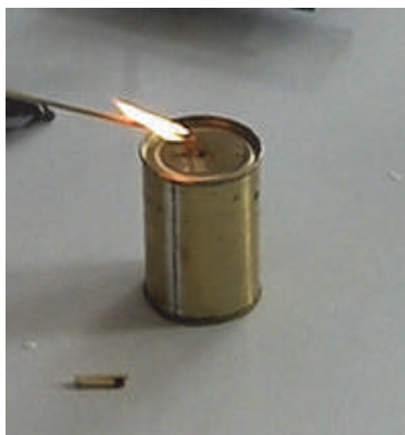
Рис. 11. Поджигаем банку с водородом
