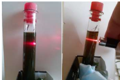
Рис. 5. Пропускание лазерного луча через растворы чистого экстракта стевии (слева) и экстракта стевии с наночастицами серебра (справа)
