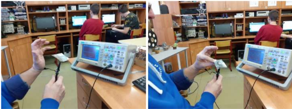
Рис. 14. Снятие показаний на осциллографе без проводника (пальца человека) и с подключением проводника (пальца)
