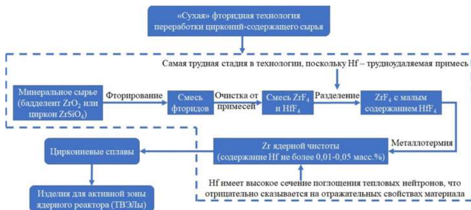
Рис. 6. «Сухая» фторидная технология переработки цирконий-содержащего сырья
