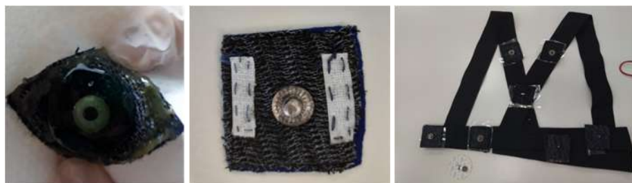
Рис. 19. Слева направо: разработанный датчик-электрод; оборот датчика-электрода; конструкция корсета и крепление электродов
