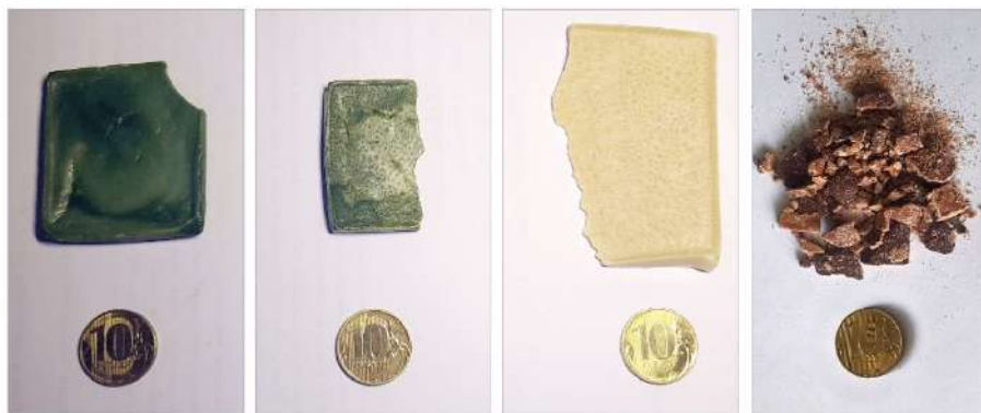
Результаты эксперимента по исследованию полирующей способности паст (слева направо: паста на основе \text{Cr}_2\text{O}_3 со стеарином; с парафином; паста на основе \text{Al}_2\text{O}_3 ; паста на основе \text{Fe}_2\text{O}_3 )
