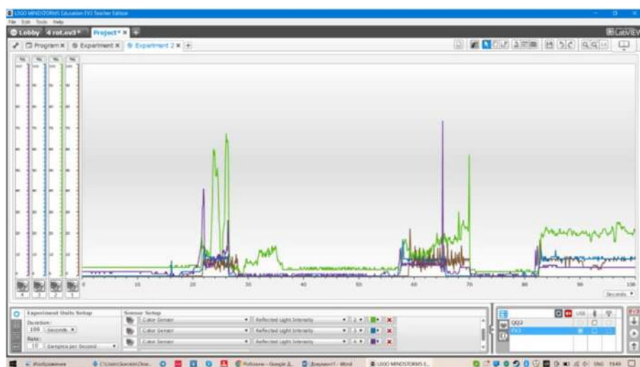
Рис. 4. Данные, полученные от датчиков отражённого света при формировании продукта
