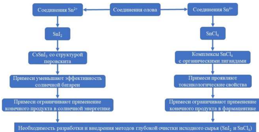
Рис. 7. Обоснование получения соединений олова высокой чистоты
