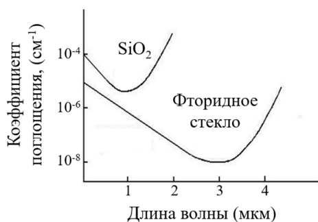
Рис. 9. График зависимости коэффициента поглощения излучения от его длины волны для разных оптических сред
