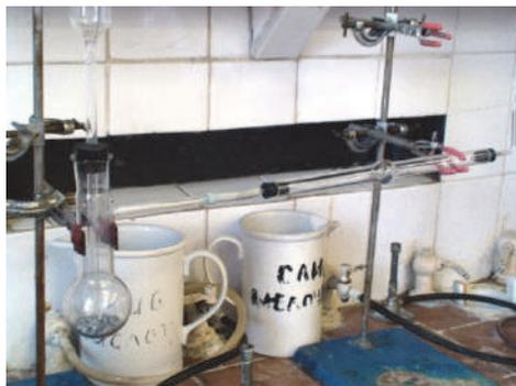
*Лабораторные приборы для восстановления оксида металла водородом (на каждом фото: слева – сосуд для получения водорода, правее – реакционная трубка, в середине которой находится оксид, справа – отвод с медной спиралью для исключения проскока пламени, на конце которого водород поджигается)*
